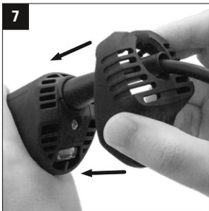
**DE** Befestigen Sie die Feinstaubschutz-Kappe wieder an der Maschine. Am besten führen Sie ihn über das Kabel und drücken im Anschluss die Befestigungs-Clips, bis diese einrasten.
