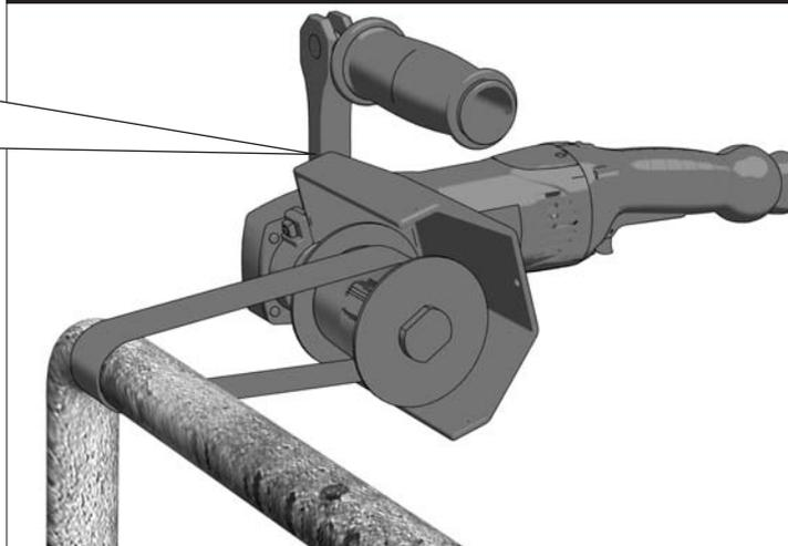
Schleif-, Vlies-, oder Polierbänder mittig über Werkstück und Schleifrolle schieben, straff ziehen und mit Stufe B-C anwenden. Die seitlichen Flansche verhindern ein Abrutschen. Die Schleifstelle durch seitliches Versetzen über die gesamte Breite bearbeiten
